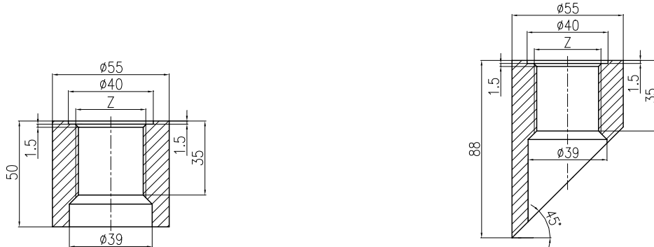
OBŘÁZEK 5 - ROZMĚROVÝ NÁKRES A TABULKA PROVEDENÍ NÁVARKŮ NVP5 A NVS5
